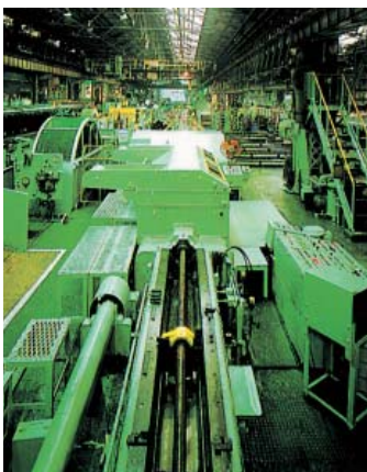
管圧延機 Cold pilger mill
